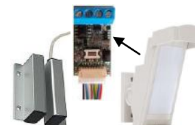
Univerzální miniaturní modul dvou binárních vstupů pro připojení externích detektorů a snímačů teploty.
